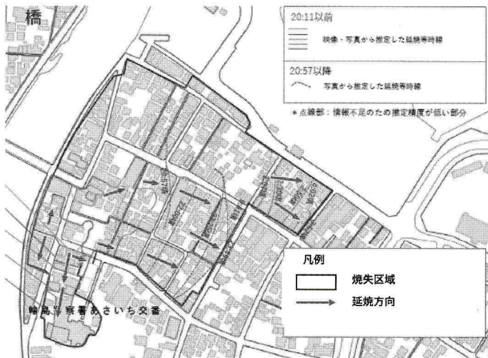
[図1] 輪島朝市通り一帯の焼失区域の延焼注*1
